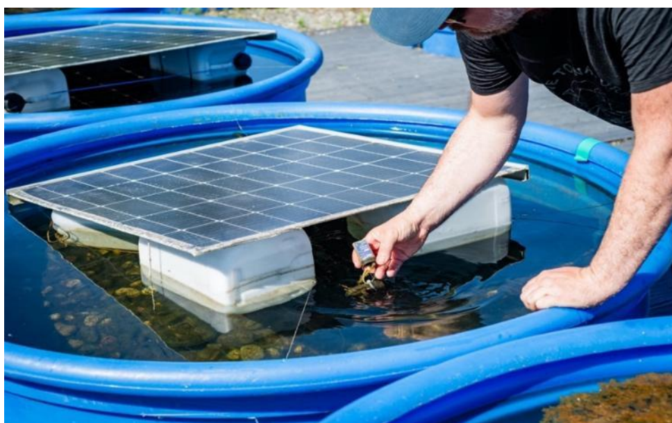
Figure 9 Installation d'un capteur-enregistreur de température dans un mésocosme.
