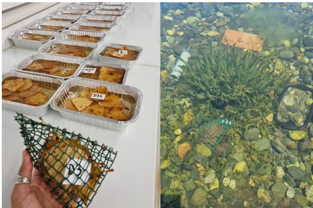
Figure 15 Préparation et installation des dispositifs pour mesurer la décomposition dans un mésocosme.
