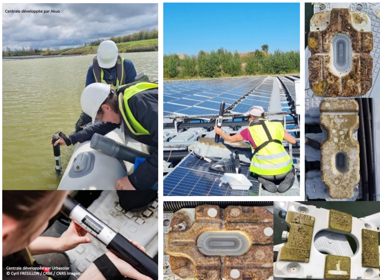
Figure 24 Mesure de la concentration en chlorophylle dans l'eau à l'aide d'un fluoromètre pélagique (à gauche) ; mesure de la biomasse algale fixée sur les flotteurs à l'aide d'un fluoromètre benthique (en haut au centre) et exemples de biofouling sur les flotteurs à l'aide d'un fluoromètre benthique (en haut au centre) et exemples de biofouling sur les flotteurs expérimentaux une fois retournés.
