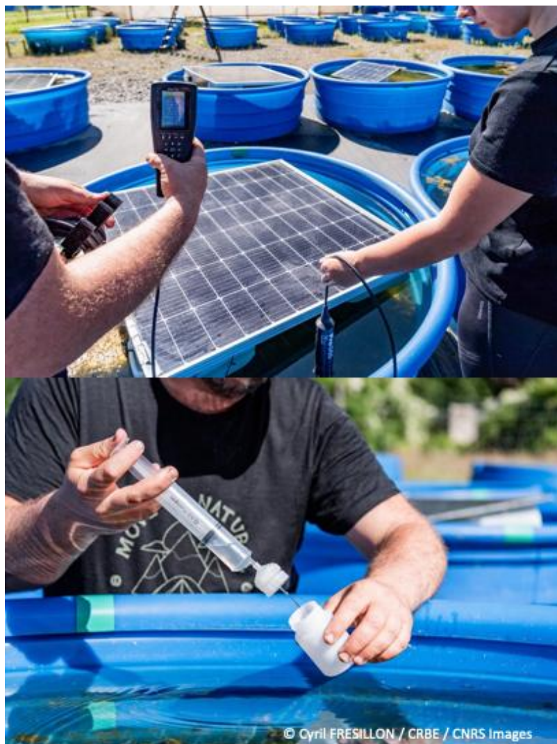
Figure 10 Mesure de paramètres physico-chimiques à l'aide d'une sonde multi-paramètre et prélèvement d'eau filtrée dans un mésocosme.
