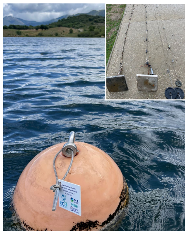
Exemple de dispositif de suivi de la température d'un plan d'eau sur le lac de Padula (Réseau national de thermie). En haut à droite, exemples de différents montages des parties submergées du dispositif.
